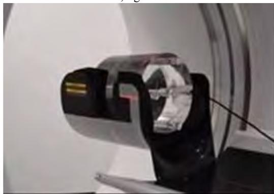
Figura 33. Posicionamiento del maniquí de cráneo y cámara de ionización para la ejecución de pruebas dosimétricas.
