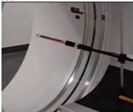
Figura 32. Geometría empleada para la medición del índice de *kerma* en aire libre en TC  $C_{a,100}$ .
