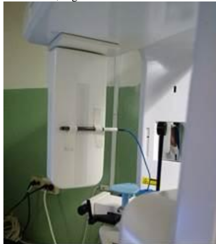
Figura 13. Posicionamiento del sistema de medida para la determinación del kerma en aire a la entrada del paciente.
