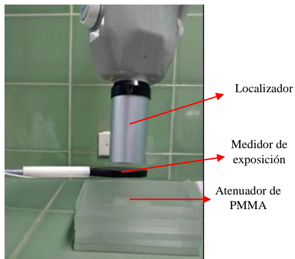
Figura 7. Configuración experimental para mediciones del kerma en aire a la entrada del paciente.
