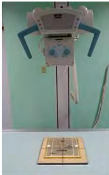
Figura 31. Configuración para verificación de la linealidad espacial
