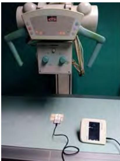
Figura 16. Medidor de exposición ubicado sobre la mesa radiológica, centrado con respecto al haz de radiación
