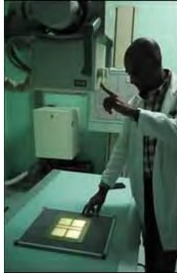
Figura 6. Posicionamiento de la herramienta de colimación
