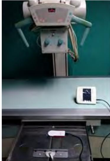
Figura 17. Medidor de exposición situado en la bandeja del *bucky* de mesa, debajo del sistema de rejilla
