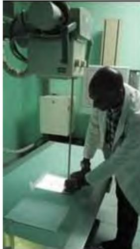
Figura 1. Evaluación de la exactitud de la escala indicadora, cuando se conoce la posición del punto focal
