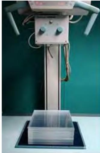
Figura 18. Geometría inicial. Maniquí de PMMA y sistema de detección sobre mesa radiológica
