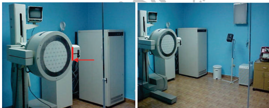
Fig. 4.7. Soporte para colocación de la fuente para la determinación de la tasa máxima de conteos. El soporte se desplaza acercándose al detector.
