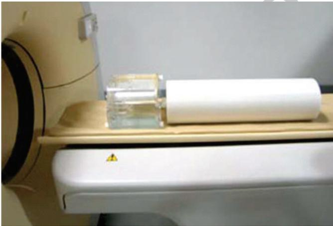
**Fig. 6.5.** Ubicación de los maniqués para la prueba de calidad de imagen.
