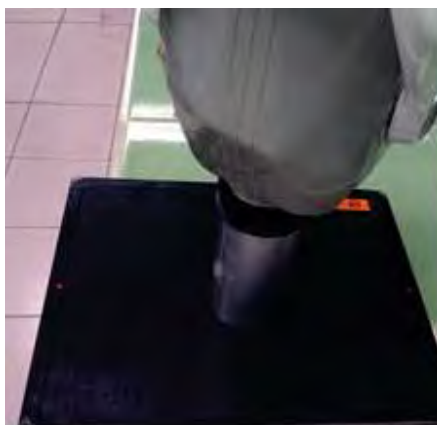
Figura 3. Posicionamiento del localizador en contacto con la película radiográfica, para la evaluación del tamaño del campo.
