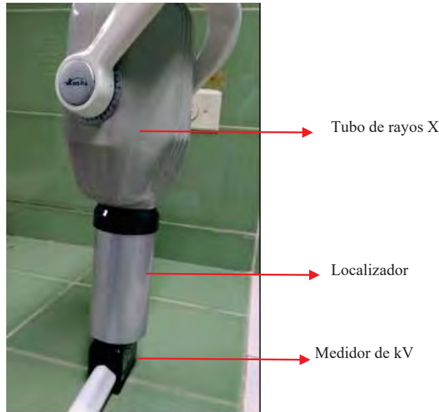
Figura 5. Geometría para evaluación de la exactitud de la tensión.
