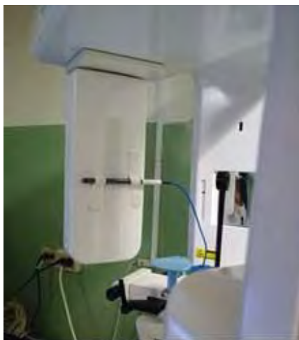
Figura 13. Posicionamiento del sistema de medida para la determinación del kerma en aire a la entrada del paciente.
