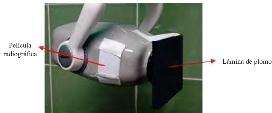
Figura 1. Ubicación del sistema de detección próximo al soporte del tubo de rayos X, para la evaluación de la radiación de fuga.
