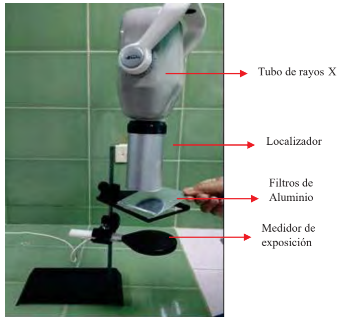
Figura 6. Posicionamiento y alineación de la instrumentación requerida para la determinación de la capa hemirreductora.
