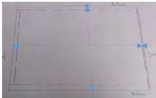
Figura 4. Determinación cuantitativa de la penumbra en los bordes del campo de luz visualizado. La región enmarcada entre las líneas continuas y discontinuas constituyen la zona de penumbra
