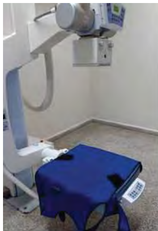
Figura 33. Protección del detector de panel plano con ayuda de un delantal plomado
