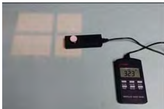
Figura 5. Ubicación del fotómetro para la medida cuantitativa de la iluminación del campo de luz
