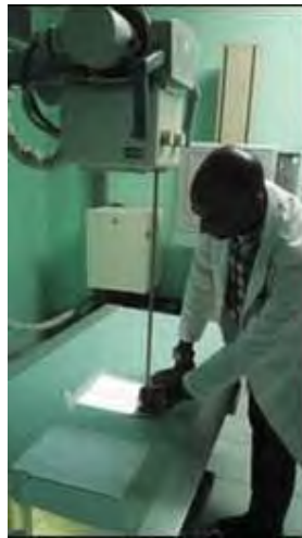
Figura 1. Evaluación de la exactitud de la escala indicadora, cuando se conoce la posición del punto focal
