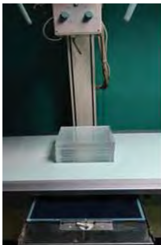
Figura 19. Geometría final para la determinación del FR cuando se utiliza un maniquí de PMMA
