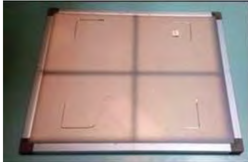
Figura 8. Apertura del colimador hasta alcanzar los bordes del chasis
