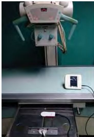
Figura 17. Medidor de exposición situado en la bandeja del bucky de mesa, debajo del sistema de rejilla
