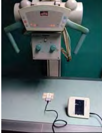
Figura 16. Medidor de exposición ubicado sobre la mesa radiológica, centrado con respecto al haz de radiación
