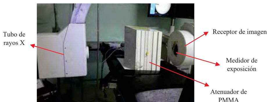
Figura 12. Montaje experimental propuesto para fluoroscopios
