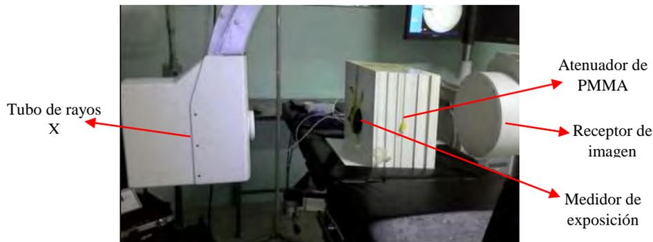
Figura 10. Disposición del sistema para la determinación del valor del rendimiento
