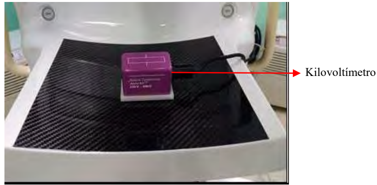
Figura 10. Ubicación del kilovoltímetro sobre el soporte de la mama
