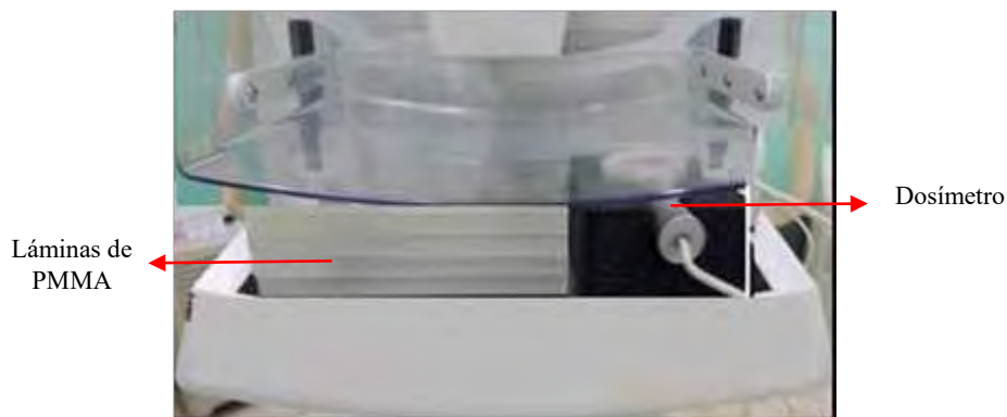
Figura 28. Ubicación del maniquí y detector de radiación para la prueba de repetibilidad del CAE
