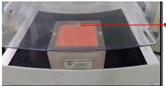
Figura 14. Posicionamiento del maniquí y disco de acrílico sobre el soporte de la mama
