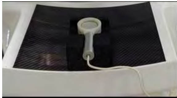
Figura 16. Posicionamiento del dosímetro para la determinación de la kerma en aire incidente
