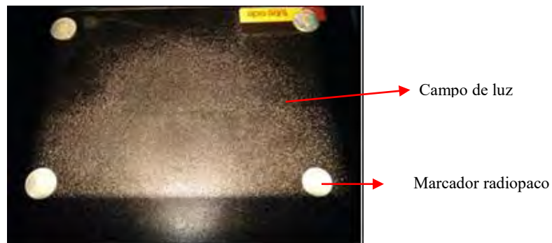
Figura 4. Emplazamiento de los marcadores radiopacos para delimitar campo de luz
